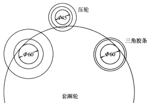
图1 三角胶条热贴装置的操作工艺示意
