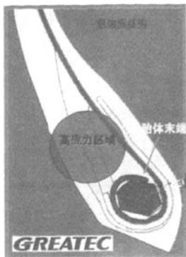
图7 胎体末端包胎圈结构
