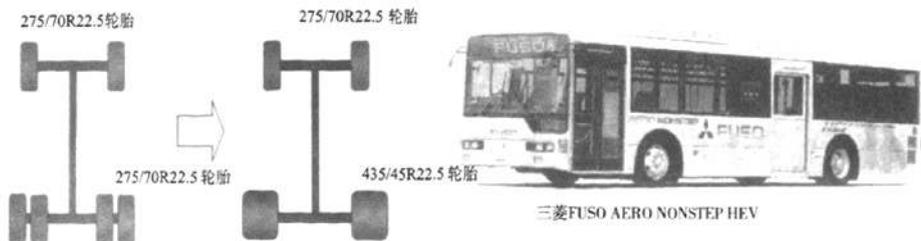
图 1 客车宽基轮胎单胎代替普通轮胎并装双胎示意
