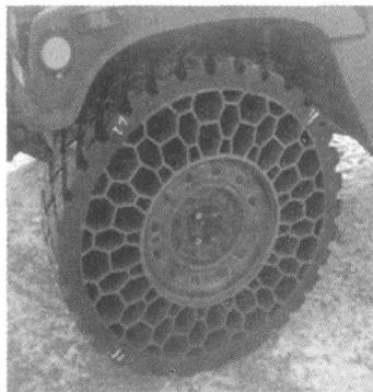
图1 装配在悍马越野车上的蜂巢轮胎
