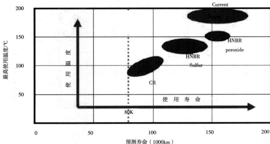
图 7 同步带使用寿命预测
