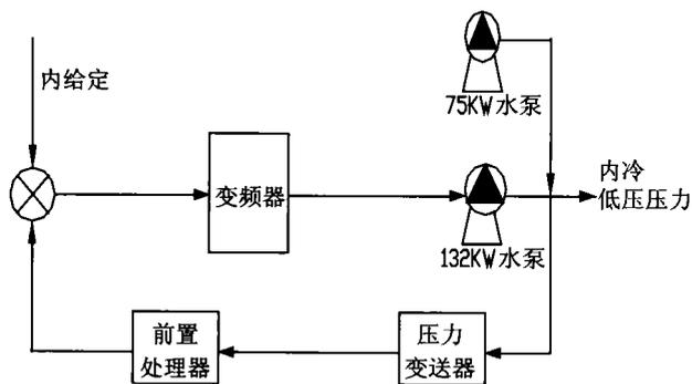
图 4 内冷管道压力自动控制图
