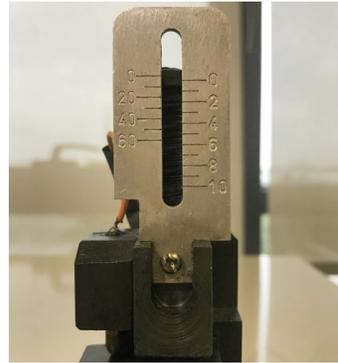
图2 WJJ-6C型机动弯折试验机张紧力控制装置
