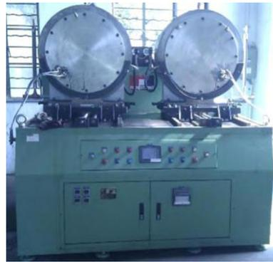
图4 双轴旋转油封试验台架
