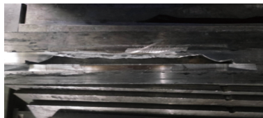
图7 口型板上板后口倒角
