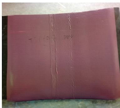
图5 大规格轮胎胎面底部不平
