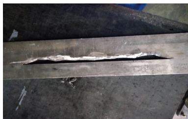
图4 大规格轮胎胎面口型板开型
