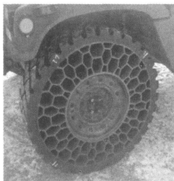
图1 装配在悍马越野车上的蜂巢轮胎
