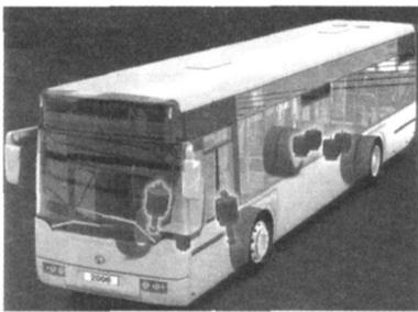
图 1 汽车空气弹簧悬架安装位置示意
