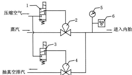
1, 3—电磁阀; 2, 4—气动二位三通切断阀;
