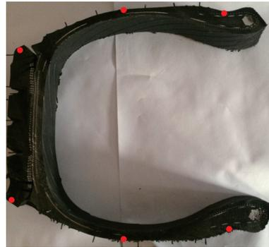
图1 轮胎测温点示意
