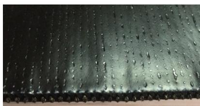
图3  $3 \times 0.24/9 \times 0.225$  CCST 钢丝帘布裁断断面
