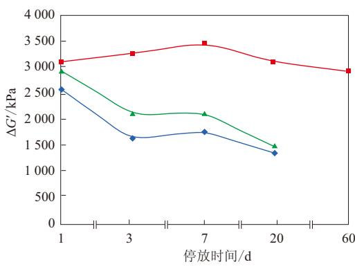
图2 停放时间对SSBR胶料 $\Delta G'$ 的影响
