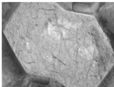
图2 试验配方轮胎的胎面磨损状况
