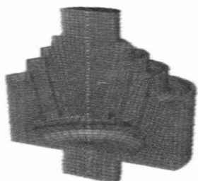
图 8 轴箱弹簧的有限元网格模型
