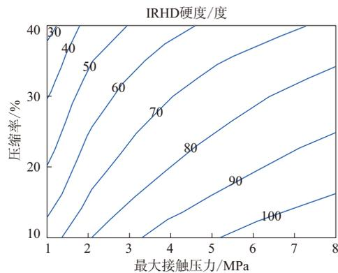
图3 O形圈IRHD硬度与压缩率和最大接触压力关系的等高线
