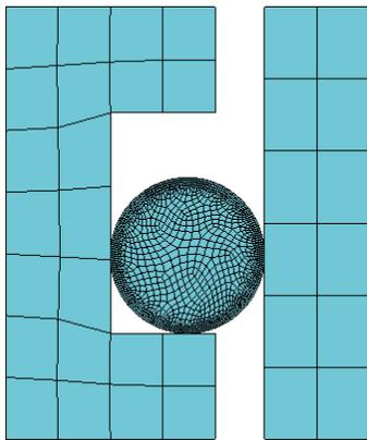
图1 O形圈的有限元模型示意
