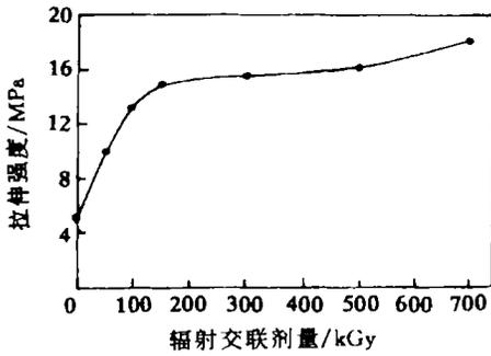
图2 辐射交联剂量对拉伸强度的影响
