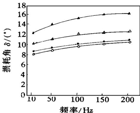
图1 频率与损耗角的关系
