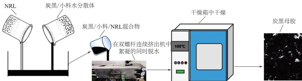
图1 炭黑母胶制备的工艺流程
