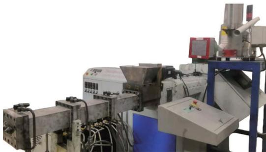
图2 连续混炼机
