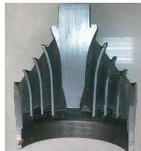
图13 优化结构锥形弹簧疲劳试验后的切面状况
