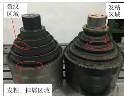
图12 优化结构锥形弹簧疲劳试验后的外观情况
