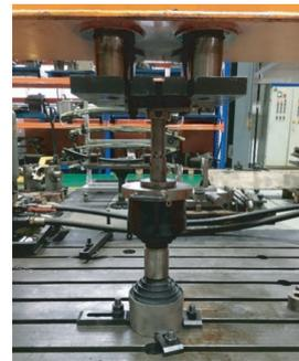
图11 锥形弹簧疲劳试验的安装效果
