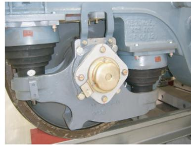
图1 锥形弹簧安装示意
