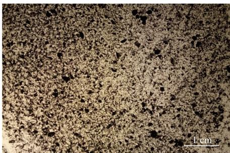
图8 SWCNT用量为0.1份的防静电羧基丁腈胶乳手套胶膜储存2个月后的显微镜照片
