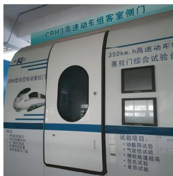
图9 气密性试验台架
