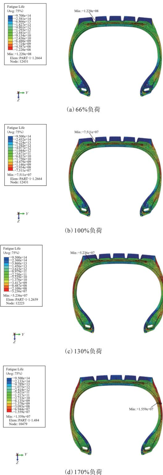
图10 不同加载条件下轮胎断面疲劳寿命分布和橡胶制品在不同负荷和使用环境下的疲劳寿命进行预测。准确的橡胶材料疲劳仿真分析还依赖于对橡胶材料疲劳耐久性机理的研究和可靠的材
