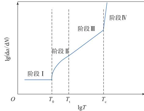
图7 Lake-Lindley橡胶材料裂纹扩展模型
