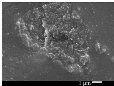
图3 炭黑聚集体扫描电子显微镜(SEM)图像
