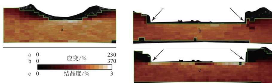
图2 不同应变条件下NR的结晶现象WAXD图
