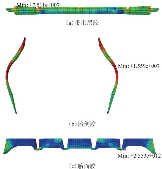
图9 轮胎部件开裂方向的临界平面分析
