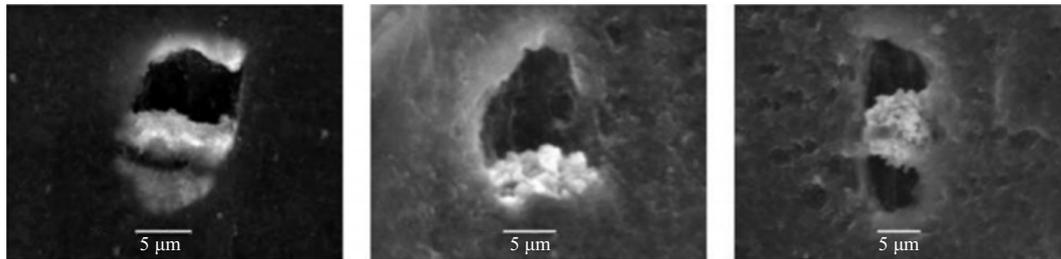
图4 氧化锌引发的橡胶材料初始裂纹SEM照片
