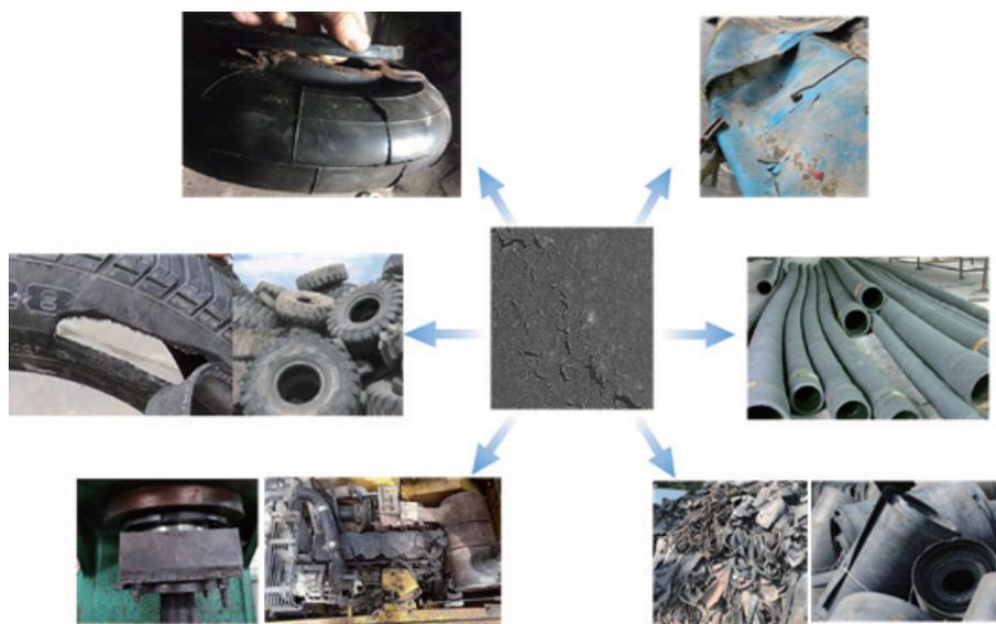
图1 橡胶材料疲劳导致的橡胶制品失效现象
