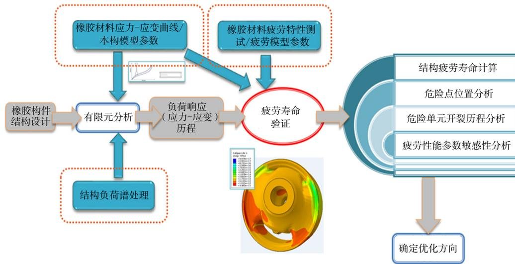
图8 橡胶构件疲劳耐久性分析流程
