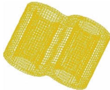
图4 四棱异步转子流场网格模型
