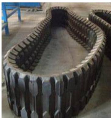
图4 整体式橡胶履带
