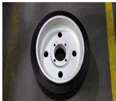
图7 实心橡胶车轮
