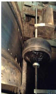
图8 负重轮台架试验
