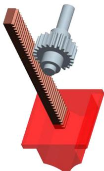
图3 压砣控制示意
