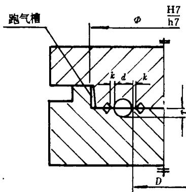
图 2 O 型密封圈外定心单腔模图例
