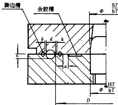
图 1 O 型密封圈内定心单腔模图例
