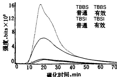
图 8 以 TBBS 和 TBSI 为基础的普通和高促-低硫有效硫化体系在 140°C 硫化时 BTH 的释放
