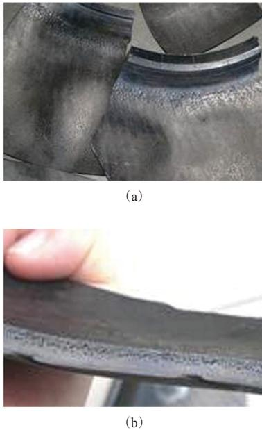
图48 胶囊内部(上卡盘侧)出现大面积碎气泡状程度不足时,易产生胶囊内表面局部出泡。
