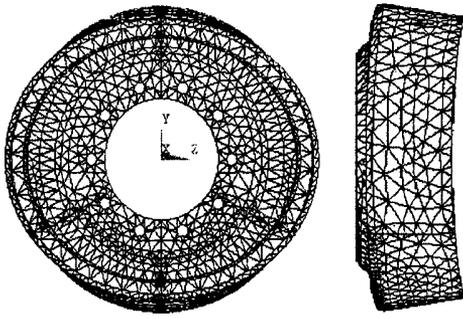
图2 一阶振型图(439.87 Hz)
