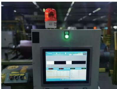
图5 异物检测主机操作柜
