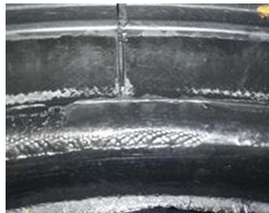
图5 胎圈大边消失、胎圈疤痕存在
