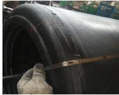
图4 成型过程中控制25 mm的贴合高度
