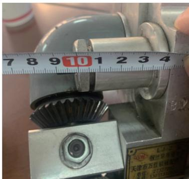
图5 缝合器碟簧片间隙测量示意
