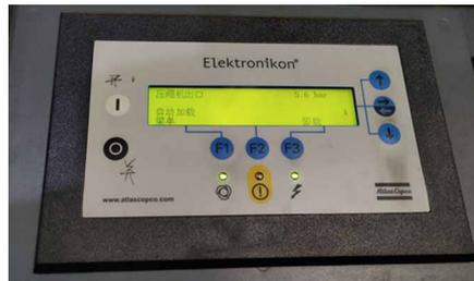
图3 中压空压机供低压空气控制台
