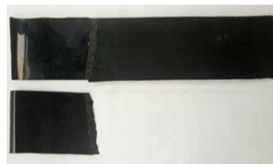
图2 未剥离、胶层破坏测试结果
