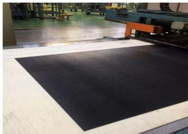
图3 0.20+6+11×0.18HT钢丝帘布正常裁断示意
