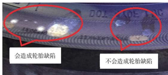
图6 隔离剂喷溅到模具上
