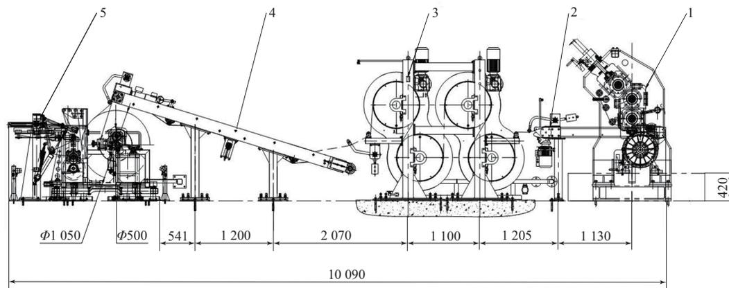
1—三辊压延机;2—接取皮带;3—四鼓冷却装置;4—爬坡输送带;5—自动卷取装置。
