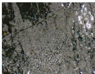
图4 反应型隔离剂形成隔离膜
