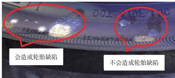
图6 隔离剂喷溅到模具上
