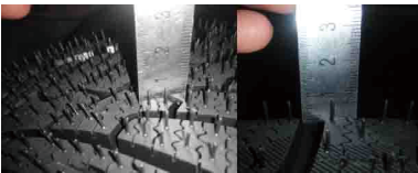
图2 胎面配方优化后花纹圆角示意
