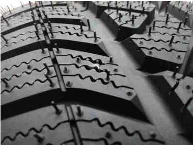
图1 胎面配方优化前花纹圆角示意
