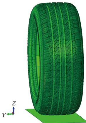
图2 带花纹轮胎的三维有限元分析模型
