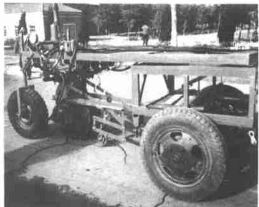
图 1 轮胎动态参数测试装置实物图
