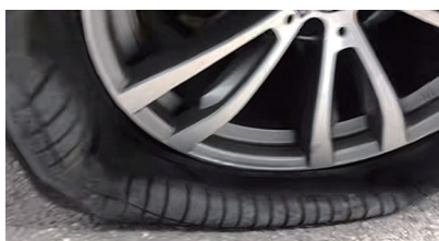
图1 普通轮胎爆胎补气时的状态
