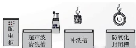
图3 超声波清洗装置
