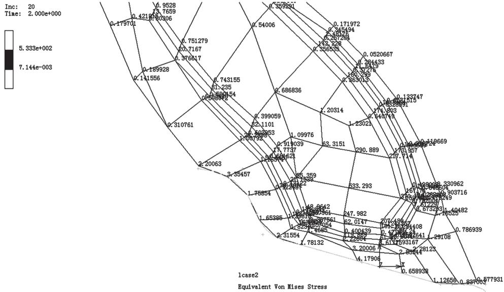
图5 B曲线轮胎充气后胎圈部位等效Von. Mises应力分布
