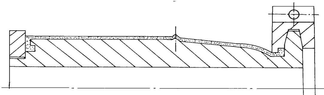
图2 反包胶囊制造工艺示意图
