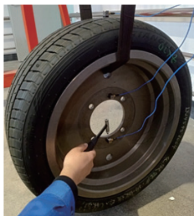
图3 轮胎轮辋总成力传递试验现场照片
