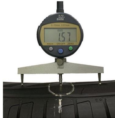
图1 使用鼓包测量仪检测轮胎鼓包位置
