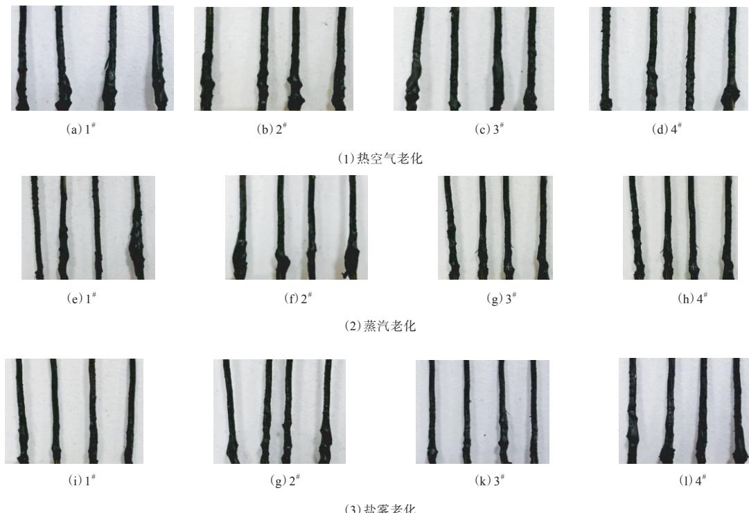
图1 抽出后钢丝帘线的附胶照片
