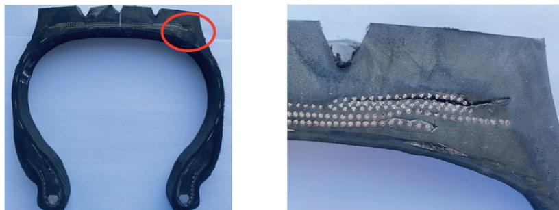
图6 生产轮胎的里程试验损坏断面
