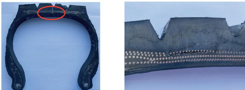
图5 试验轮胎的里程试验损坏断面
